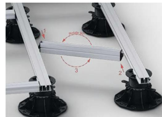
3. Conecte la sección a los largueros guía utilizando elementos P10. Para ello, inserte los elementos de unión en las ranuras de los largueros guía y gire la sección 90 grados para fijar firmemente la estructura del bastidor.
