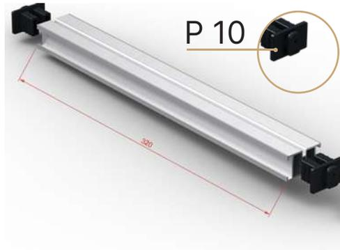
2. Prepare una sección de la barra de 320 mm de longitud e instale los elementos de conexión P10 en ambos extremos de la barra.
